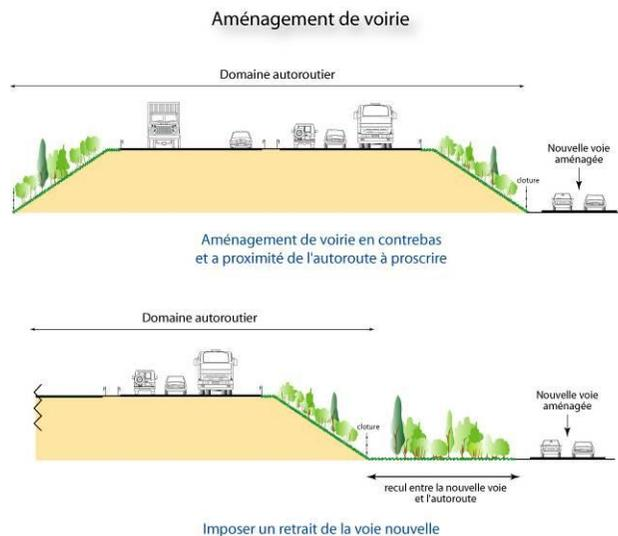
Il convient également de ne pas nuire au développement de voies ou chemins nécessaires à la gestion et à l'entretien de l'autoroute (chemins liés à la phase chantier ou à la phase de fonctionnement par exemple).
